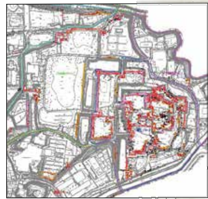
▲石垣の被害(赤色は崩落、桃色は変形、黄色は地割れ)
