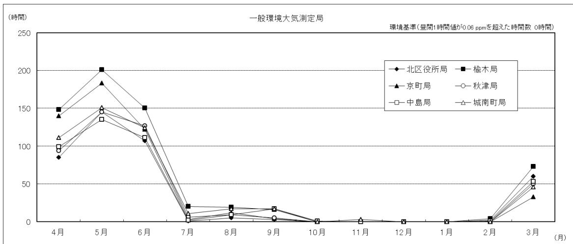
図 1-1-21 光化学オキシダントの昼間1時間値が0.06 ppmを超えた時間数推移
