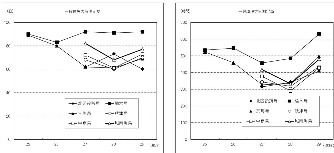
図 1-1-20 光化学オキシダントの1時間値が0.06 ppmを超えた日数(左)と時間数(右)の推移
