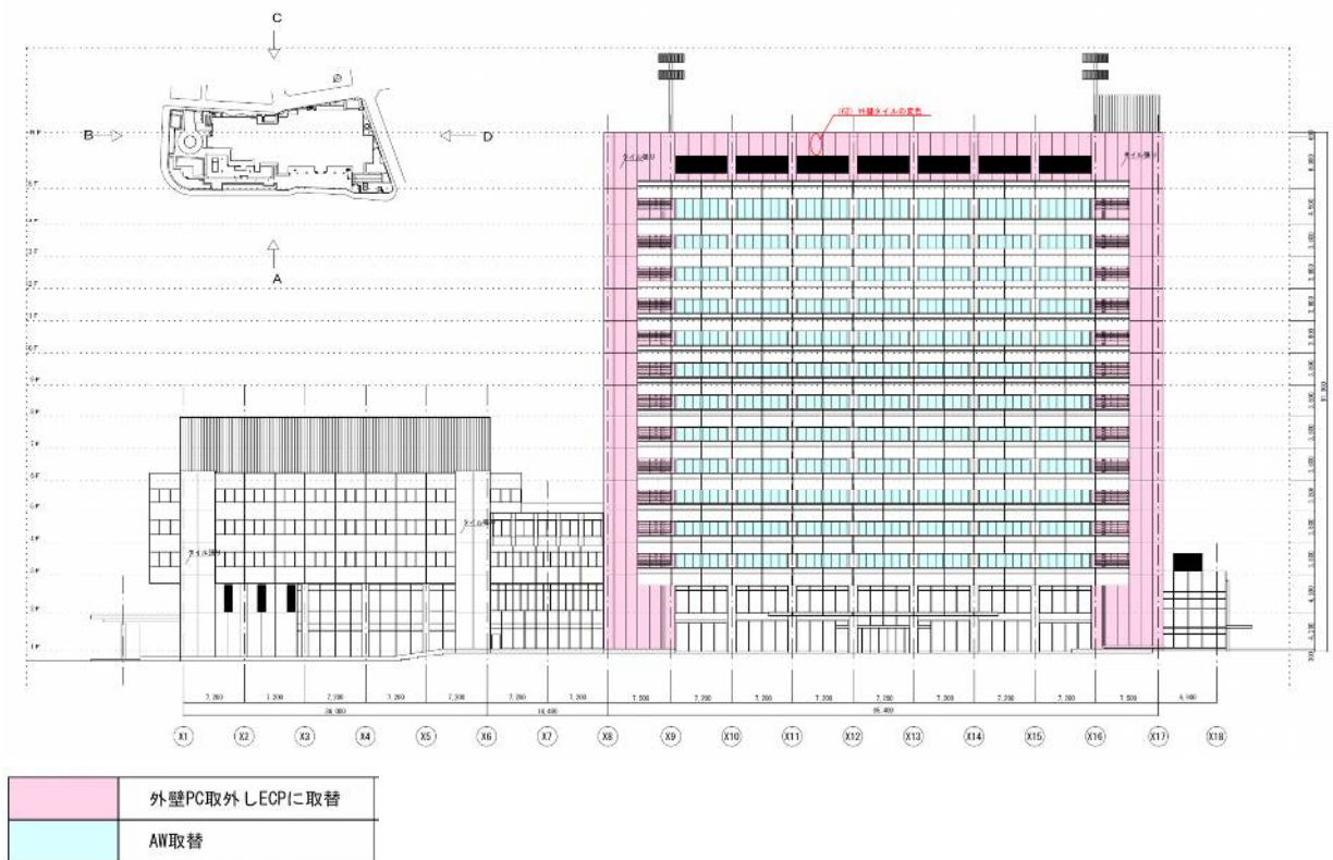
図 3.1.17 外装材の撤去交換部分
