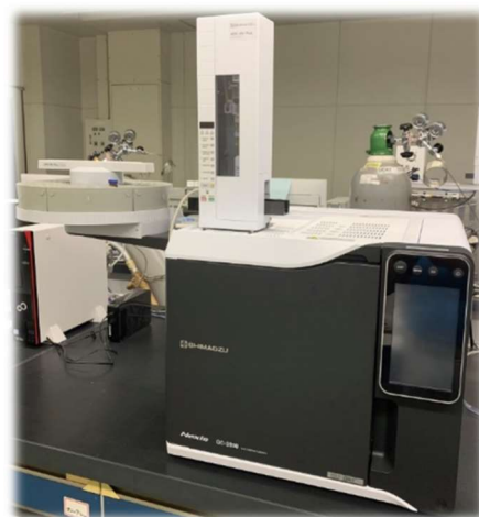
ガスクロマトグラフ分析装置 (令和元年 12 月導入)
