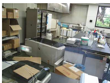
電気冷凍庫 転倒
