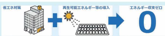
ZEBには4段階の定義があり、ZEB ReadyとZEB Orientedについては、再エネ設備を導入しなくても、エネルギー使用量の削減によりZEBランクを達成することができます。
