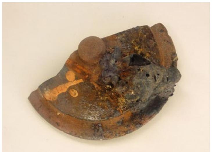
▲土瓶蓋。熔融した鉄分が付着する。
