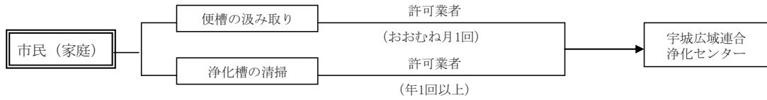
図 1 - (3) 平成 25 年度の一般廃棄物の処理システム（城南地区）
