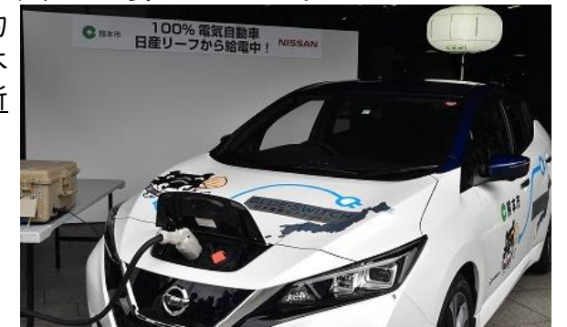
↑EV車からの給電の様子
