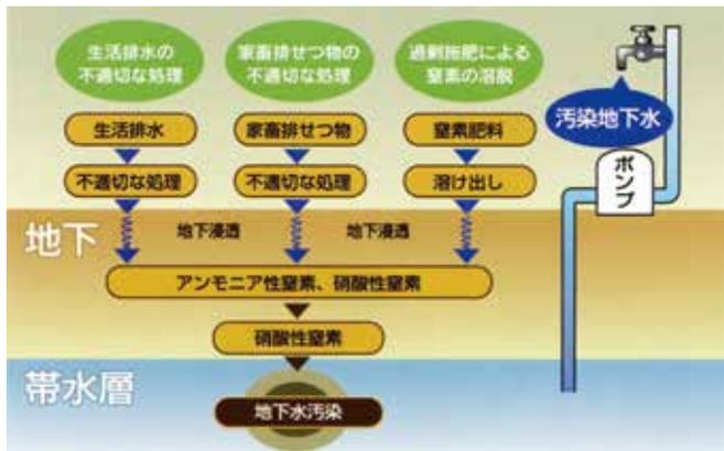
硝酸性窒素は主に肥料・家畜排せつ物・生活排水に含まれる窒素が、土壌微生物等による作用を受け発生します。硝酸性窒素は土壌に吸着されにくいので、植物吸収や脱窒等されなかった分が地下水へ移行します。
