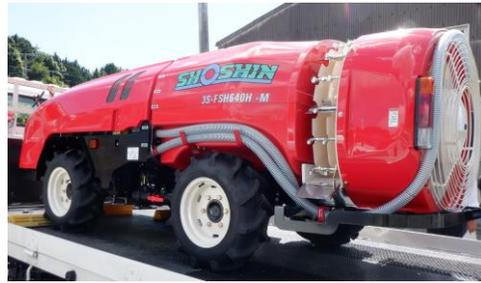
樹園地で効率よく防除作業を行うために事業により導入したスピードスプレーヤ
