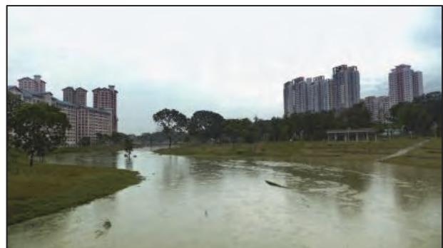
この川の水をポンプアップして、水を浄化するような事もしています(図表 32)。日本の棚田のように見えますが、土壤の基盤と植物の力を使って、川の水を浄化しています。この空間は生物棲息域としても機能する浄化ビオトープというものです。
