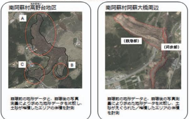
図-15 写真判読による土砂崩壊の体積計測
