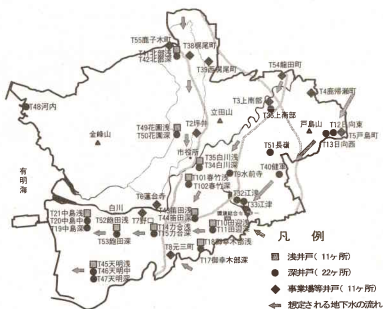
図1 地下水の流動と観測井の配置
