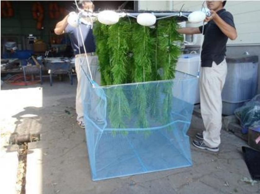
稚魚捕獲装置（塩ビパイプで作製した枠に、人工藻とナイロン地の網を取り付けたもの）を捕獲箇所を設置し、人工藻に集まる稚魚を捕獲しようとするもの。設置して約1週間の間隔をあけた後、装置を回収し網にかかった稚魚を捕獲・確認する。捕獲・確認後、同じ箇所にも再設置する。
