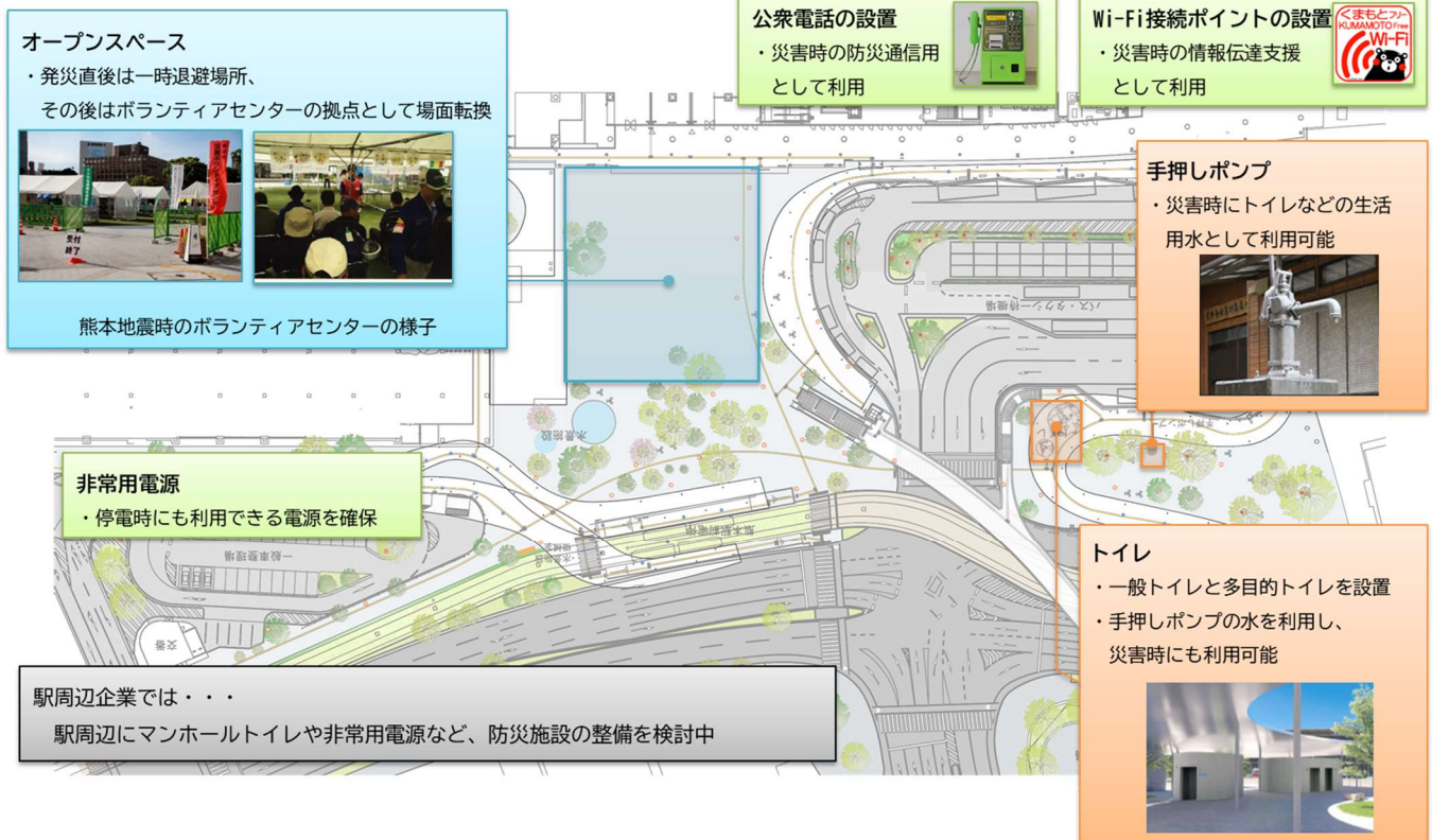
図6 熊本駅白川口駅前広場の防災施設
