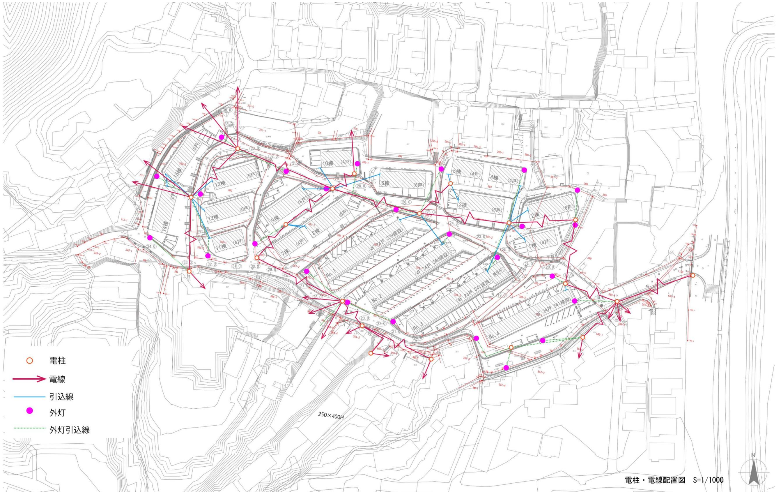
電柱・電線配置図 S=1/1000
