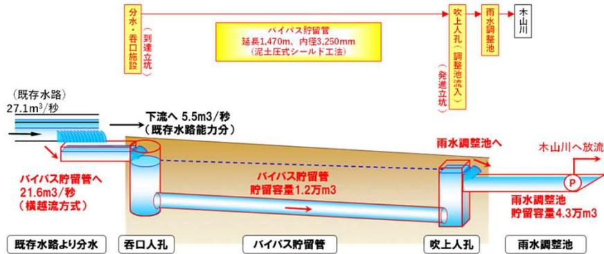
バイパス貯留管と雨水調整池
