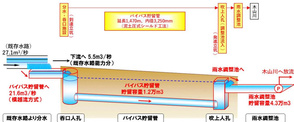
図 3-3 浸水対策の概要図 (加勢川第 6 排水区)
