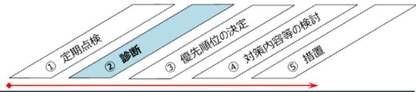
点検結果に基づき、部材単位の健全性と横断歩道橋全体の健全性を診断します。診断にあたっては、部材単位の健全性を変状の種類別の評価に応じて判定し、その結果を踏まえて横断歩道橋全体の健全性を判定します。
