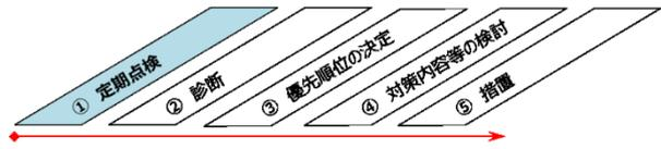
横断歩道橋の点検は、通常点検、定期点検、異常時点検の分類で実施します。本計画において、補修優先順位決定の際に指標となる横断歩道橋の状態を示す健全性については、定期点検の結果により判定します。
