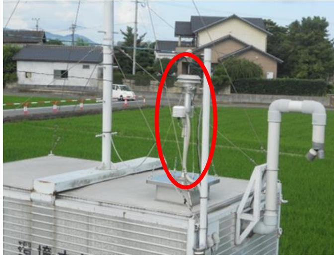
大気測定局のPM<sub>2.5</sub>測定機器（大気取入口）
