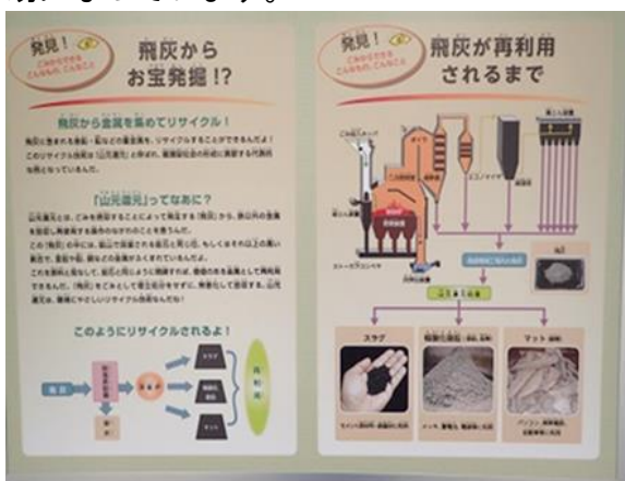
新西部環境工場の焼却灰リサイクルの過程
