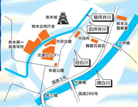
清正は、熊本城が完成すると、城のすぐ南側を蛇行する白川を直線化し、外堀として防衛線を強化しつつ、新河道との間に生じた土地に城下町を整備。また白川から分流した坪井川を水運に利用し、城下の物資輸送を盛んにする。二本木地区に残る「背割り石塘」は日本で最初の分流工事とされる。都市計画・防衛など多角的な戦略が見て取れ、土木の神様・清正公の代表的な土木事業といえる。
