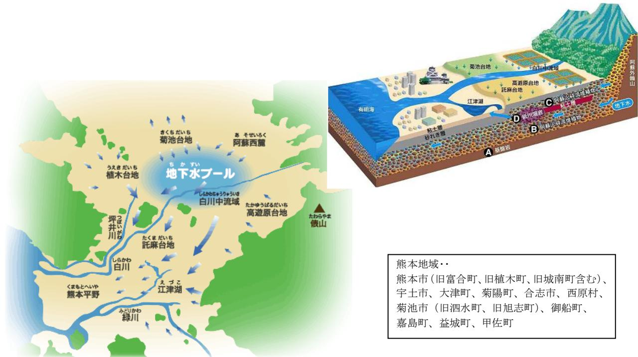
図 2-1 熊本地域の地下水のメカニズムとその流れ
