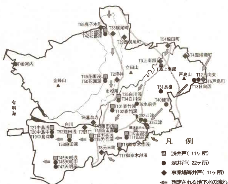
図1 地下水の流動と観測井の配置
