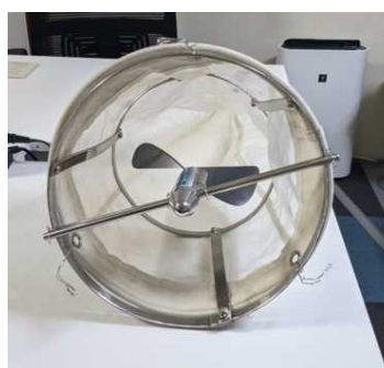
図 3-6 ②金属フレームによる固定の例
