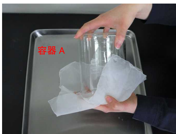
図 4-5 ⑤試料の乗った面を内側にして移し替え
