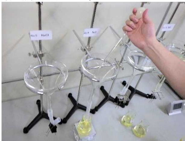
図 4-19 洗い込みの様子
