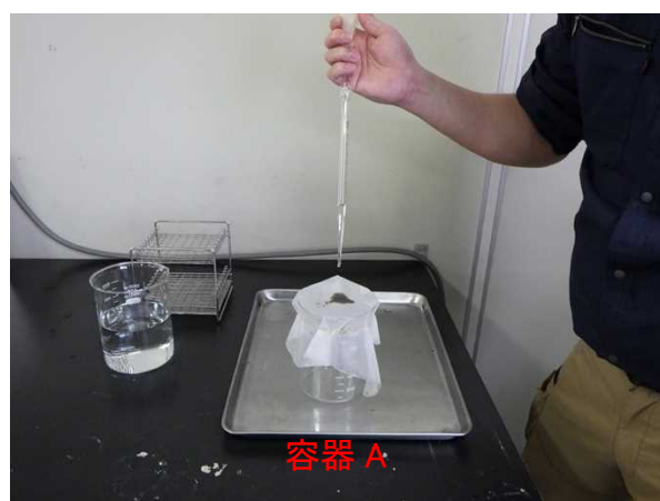
図 4-6 ⑥精製水による落とし込み
