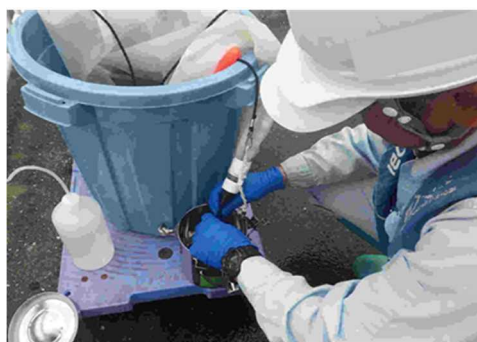
コッドエンドに集めた試料を試料保存容器へ移し替える
