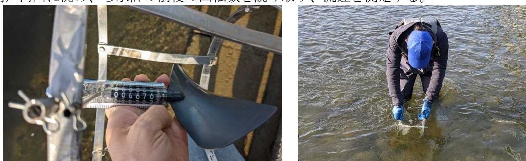
図 3-11 ろ水計を使用した流速の測定
