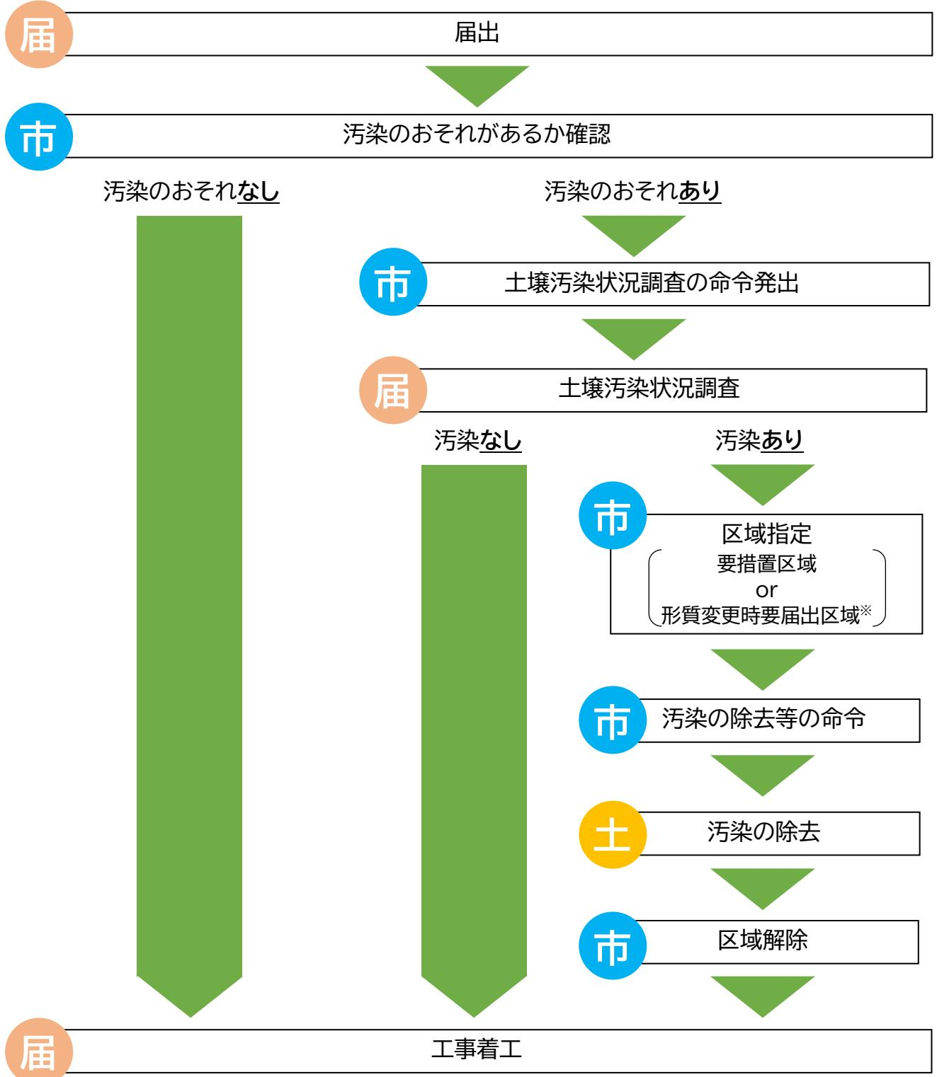
\*形質変更時要届出区域の場合、土壤汚染対策法第 12 条の届出を提出することで、形質の変更が可能。(区域外への土壌の搬出がある場合は、第 16 条の届出も必要。)
