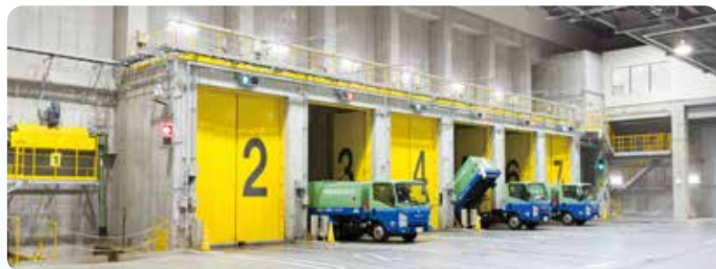
플랫폼 반입된 쓰레기는 이 곳에서 수거차에 의해 쓰레기 피트로 투입됩니다. 작업의 안전과 효율을 위해 수거차는 컴퓨터로 관제됩니다.
