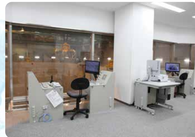
쓰레기 크레인 조작실 쓰레기 크레인 조작실에서 원격 조작으로 운전합니다. 통상 자동으로 운전합니다.
