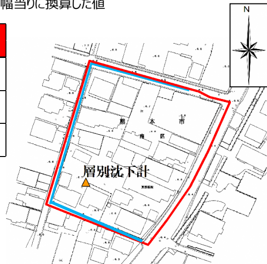
層別沈下量変動図 ※目安値とは、基準値3/1000を10m幅当りに換算した値
