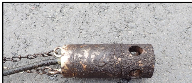
⑦地区 水位計への付着物(細粒土)
