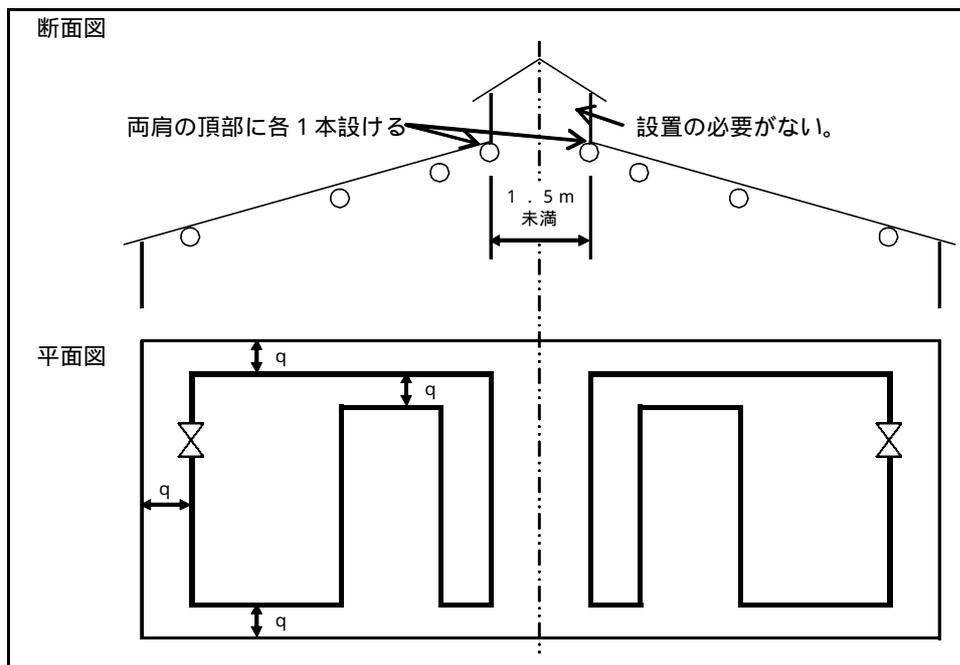
b 越屋根の両肩の間隔が1.5m以上の場合は、越屋根の合掌部分を一の感知区域とし、両肩の部分にそれぞれ1本以上の空気を設け、その他の部分は、傾斜角度が3/10以上の場合には、前(カ)に規定する傾斜天井の例により設けること。
