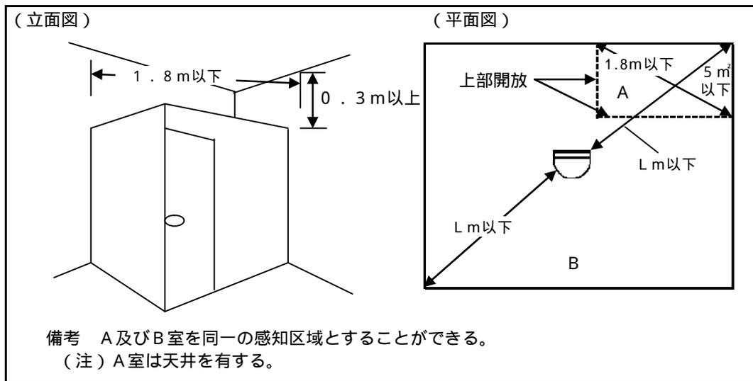
(10) 煙感知器（光電式分離型感知器を除く。以下この（9）において同じ。）の設置は、規則第23条第4項第7号の規定によるほか、次によること。
