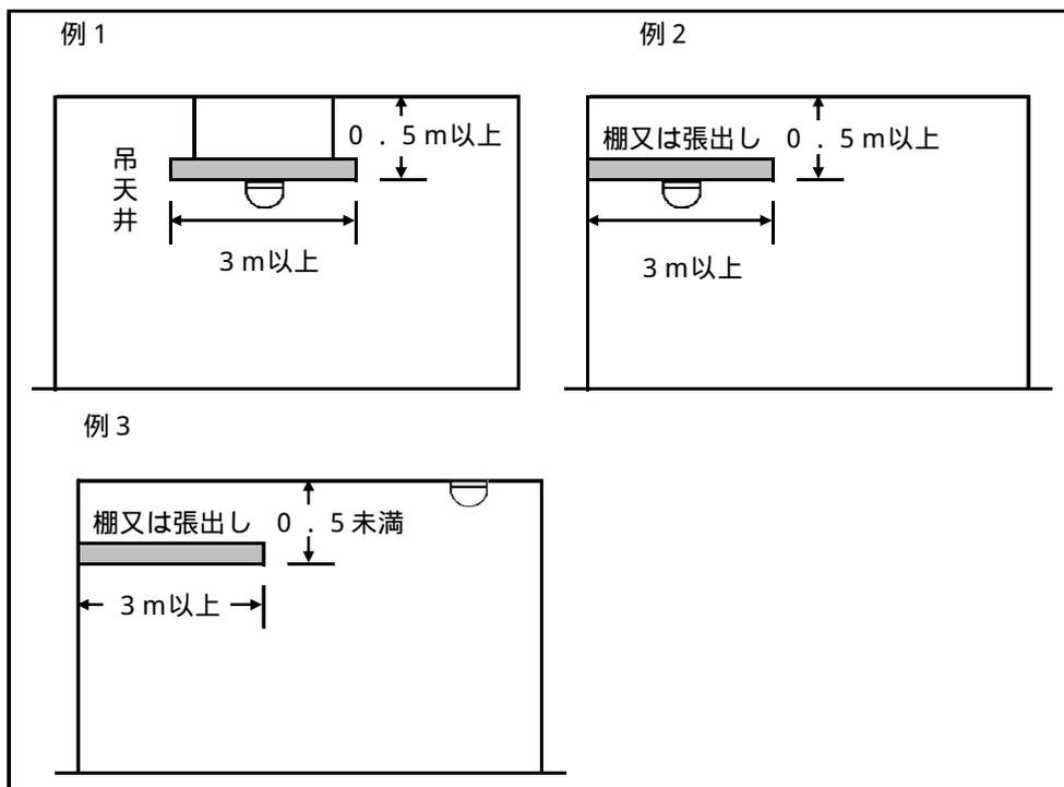
(カ) 感知器を傾斜角度3 / 10以上の傾斜天井に設ける場合は、当該床面積に必要な個数を算出し、最頂部に設けるほか、最頂部からの水平距離がL mごとに感知器の設定線を設け、そのほぼ中間に設けること。ただし、最頂部から壁面までの水平距離がL m以下となる傾斜天井部分には最頂部に設けることで足りる。この場合において、傾斜天井が左右同一の形状の場合は、左右対称となるように設けること。
