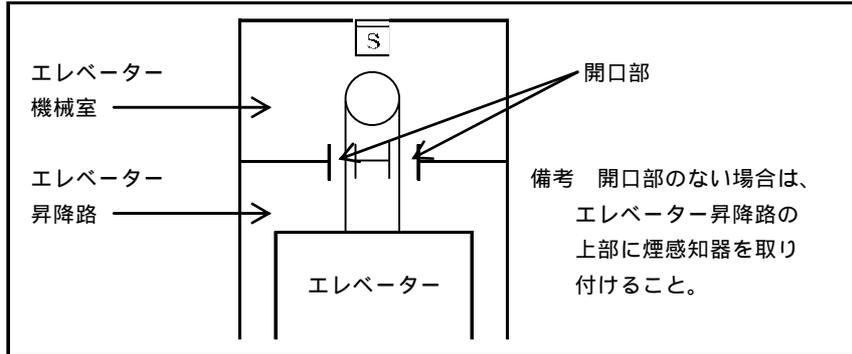
(イ) パイプシャフト等で、水平断面積が $1\text{ m}^2$ 以上ある場合は最頂部に1個以上の煙感知器を設けること。
