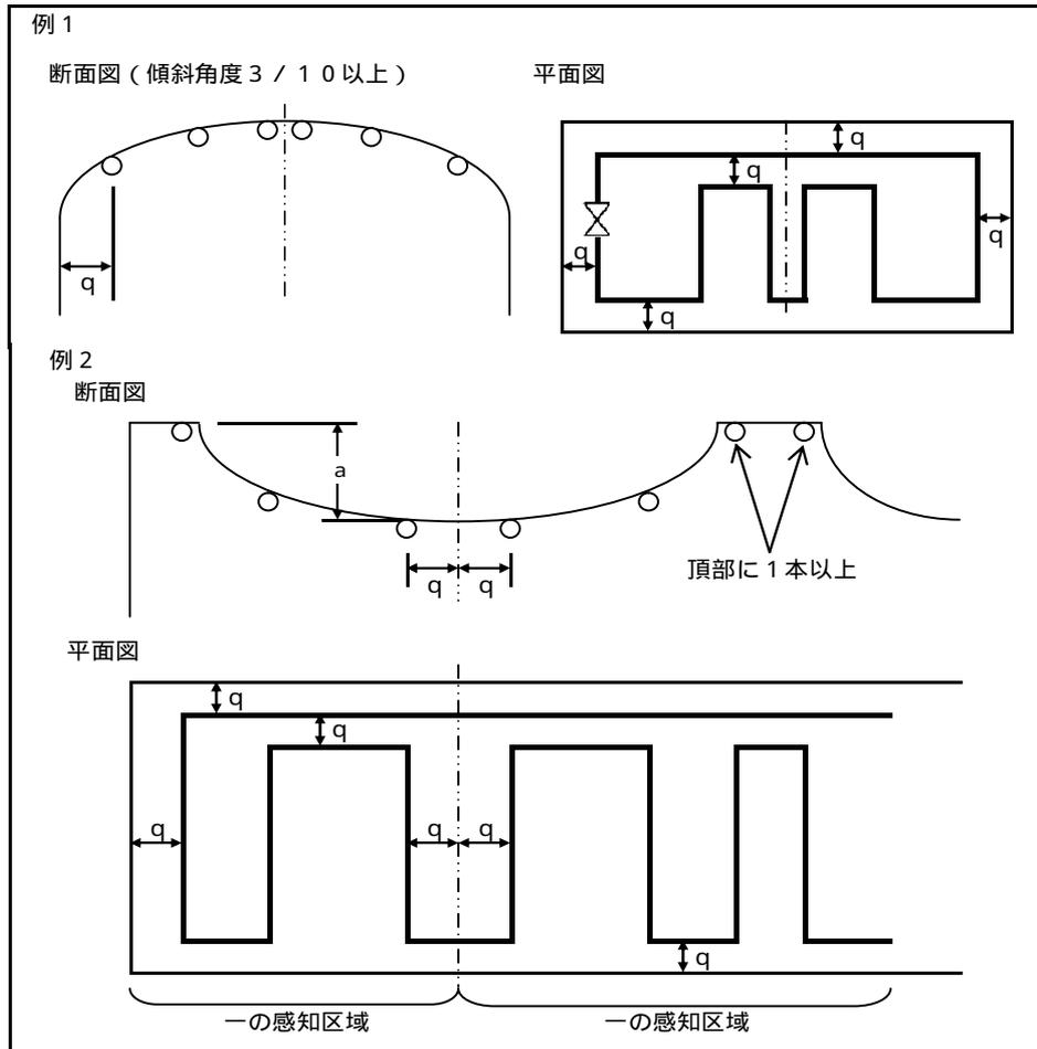
c 前aにおいて、ノコギリ型天井の頂部に設けた空気管が、直射日光等により非火災報を発するおそれのある場合には頂部から下方1.5m以下の範囲内に設けることができる。
