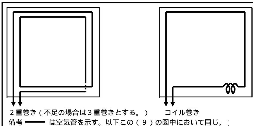
イ 規則第23条第4項第4号二に規定する空気の長さ、検出部に接続する引き込み部分を含み100m以下とすること。
