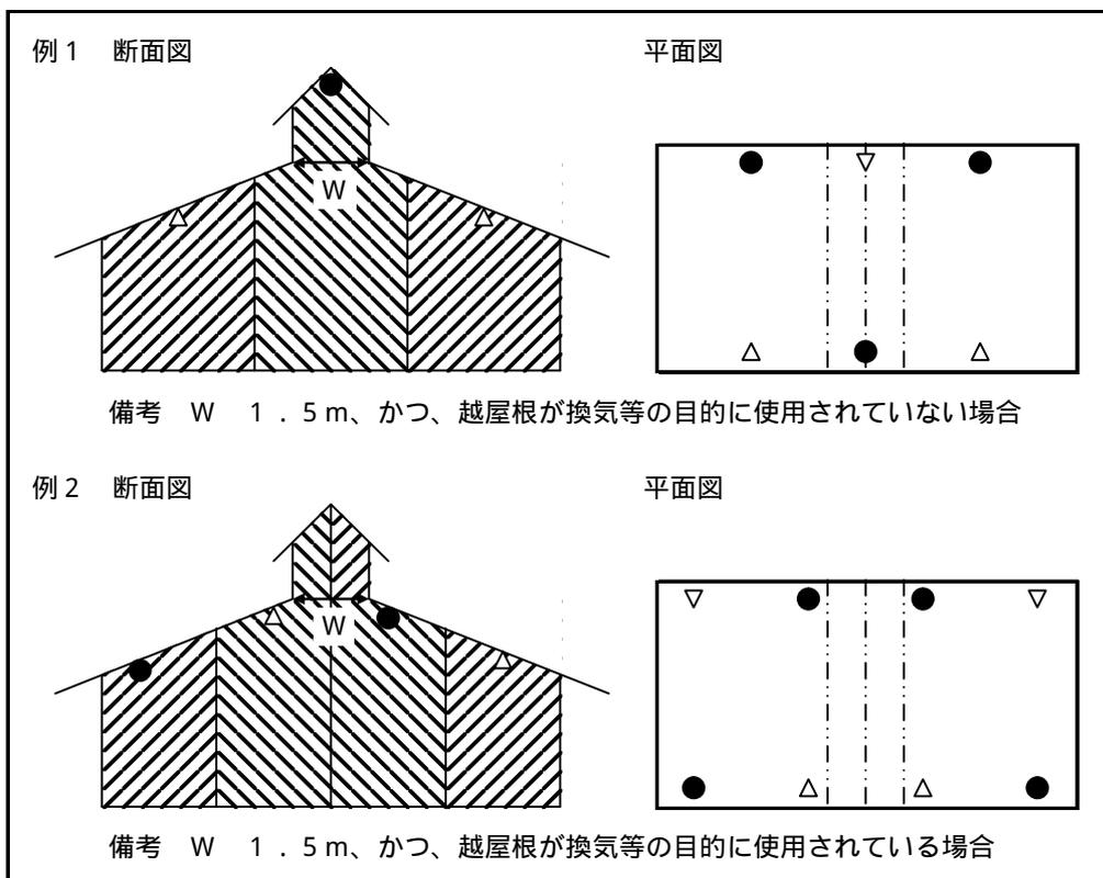
(b) 越屋根部の幅が1.5m未満の場合は、天井等の傾斜にかかわらず、当該越屋根部をささえる大棟間の中心付近に光軸が通るように監視区域を設定するとともに、順次、監視区域を隣接するように設定すること。
