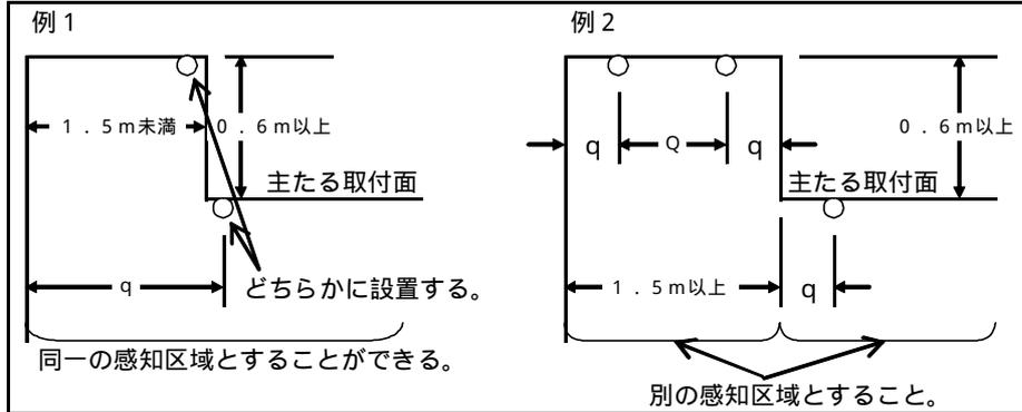
c 主たる取付面より低い段違いが中央にあり、その幅が、主要構造部を耐火構造とした防火対象物にあっては6m(5m)(( )内については主要構造部を耐火構造とした防火対象物以外の場合を示す。以下この(10)において同じ。)m未満の場合は、同一の感知区域とすることができる。ただし、その幅が6m以上となる場合はそれぞれ別の感知区域とすること。
