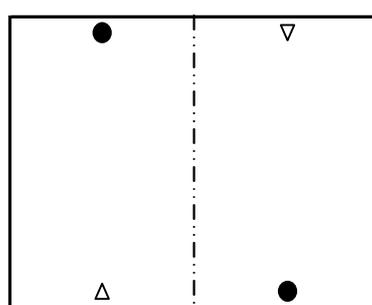
b 越屋根を有する傾斜天井等の防火対象物に光電感知器を設置する場合は、次によること。
