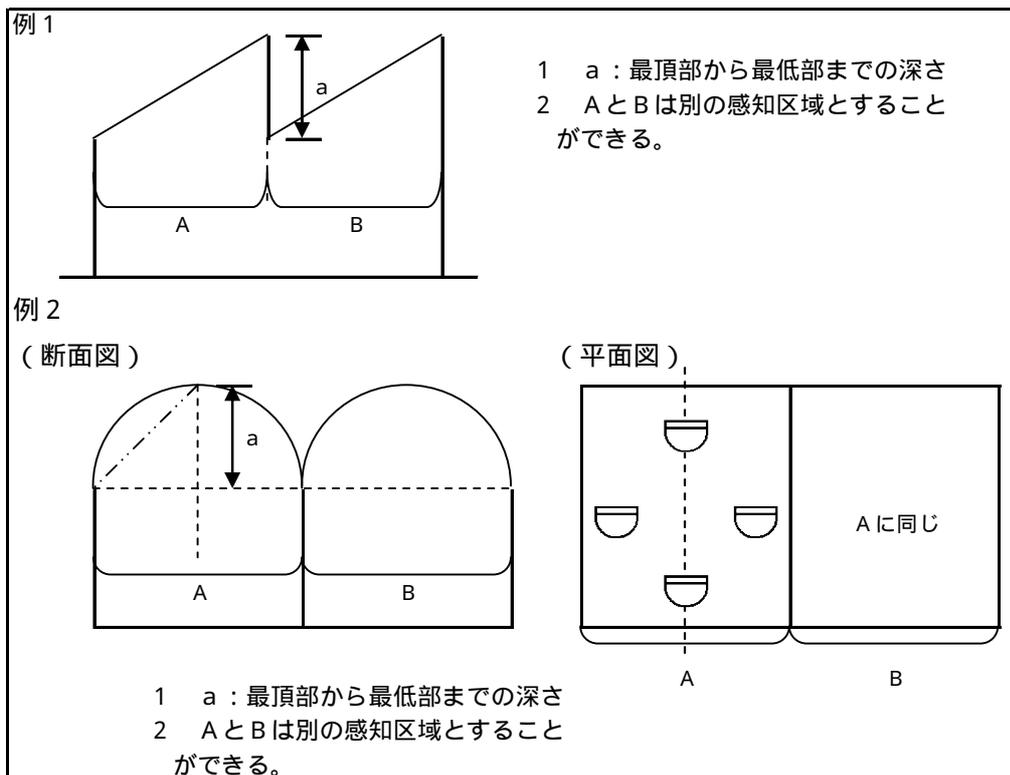
ウ 点検困難な場所又は点検の際人命危険のある場所（電気室、変電室等の高圧線の上部等）に差動式スポット型感知器を設ける場合は、当該場所の入口付近に差動スポット試験器を次により設けること。
