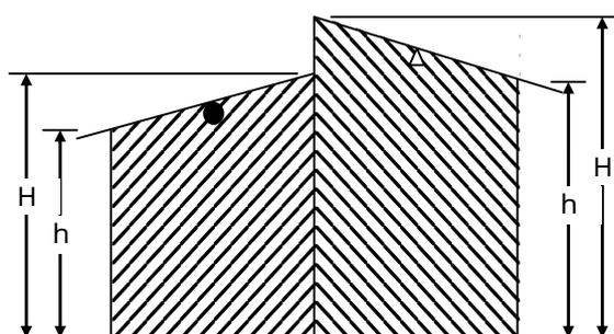
備考  $h_1 \geq 0.8 H_1$  又は  $h_2 \geq 0.8 H_1$
