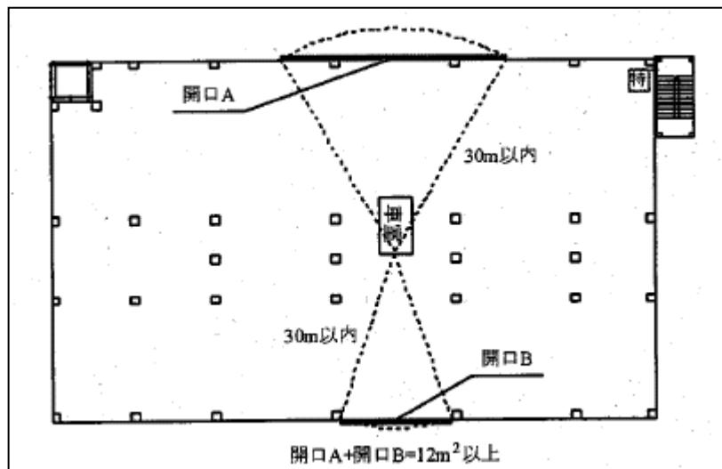
《車室の各部分から水平距離30m以内の外周部の12m<sup>2</sup>以上の有効開口部の例》
