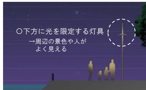
灯具高の浅い配光制御されたグレアレスなポールライトへ変更することにより、路面の明るさが確保されるとともに、周囲の視認性を高めることができます。同時に、水辺への光漏れ（生態系への影響軽減）やエネルギー効率にも寄与されます。
