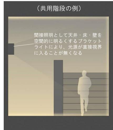
夜間の中高層建築物は、共用部から漏れる光がその建物の印象となります。特に共用階段の照明は、例えば間接照明として天井・床・壁を空間的に明るくするブラケットライトを壁面に設置することにより、光源が直接的に視界に入ることなく、また、共用階段を外から眺めても不快な眩しさが無く、夜間景観として魅力にも寄与します。
