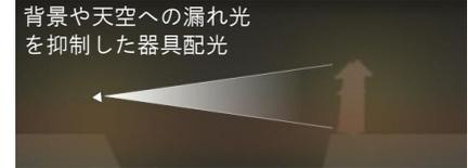
天守閣と同様に角の強調と抑揚のあるライトアップにより熊本独自のアイデンティティを高めることができます。また、光の拡散を抑制し、効率の良い器具選定により、光害及び消費電力を軽減することができます。
