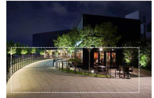
●●アイレベルやデッキ下から光源が直接見えない照明器具で構成することにより、デッキ上から街並みがよく見えるとともに、デッキ下から見上げる際の眩しさが抑制されます。
