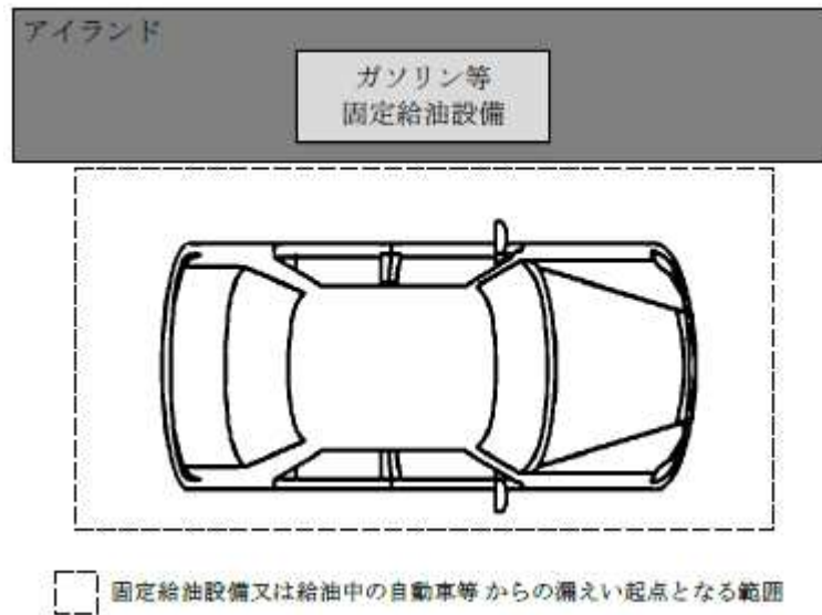
図4 漏えい起点となる範囲
