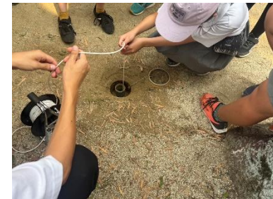
写真2_地下水位観測の様子
