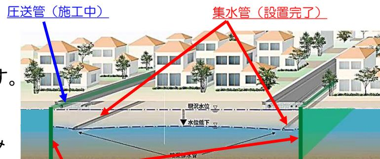
鋼矢板(設置完了) 地下水水位低下工法イメージ図
