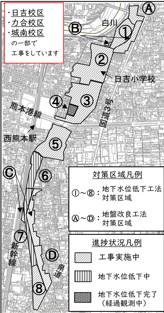
液状化対策区域の進捗状況
