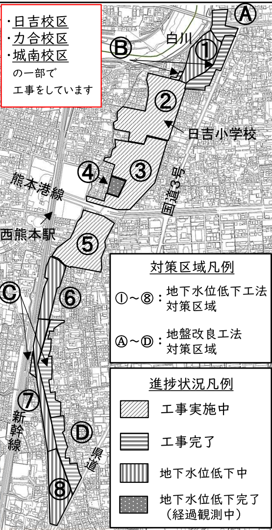
液状化対策区域の進捗状況
