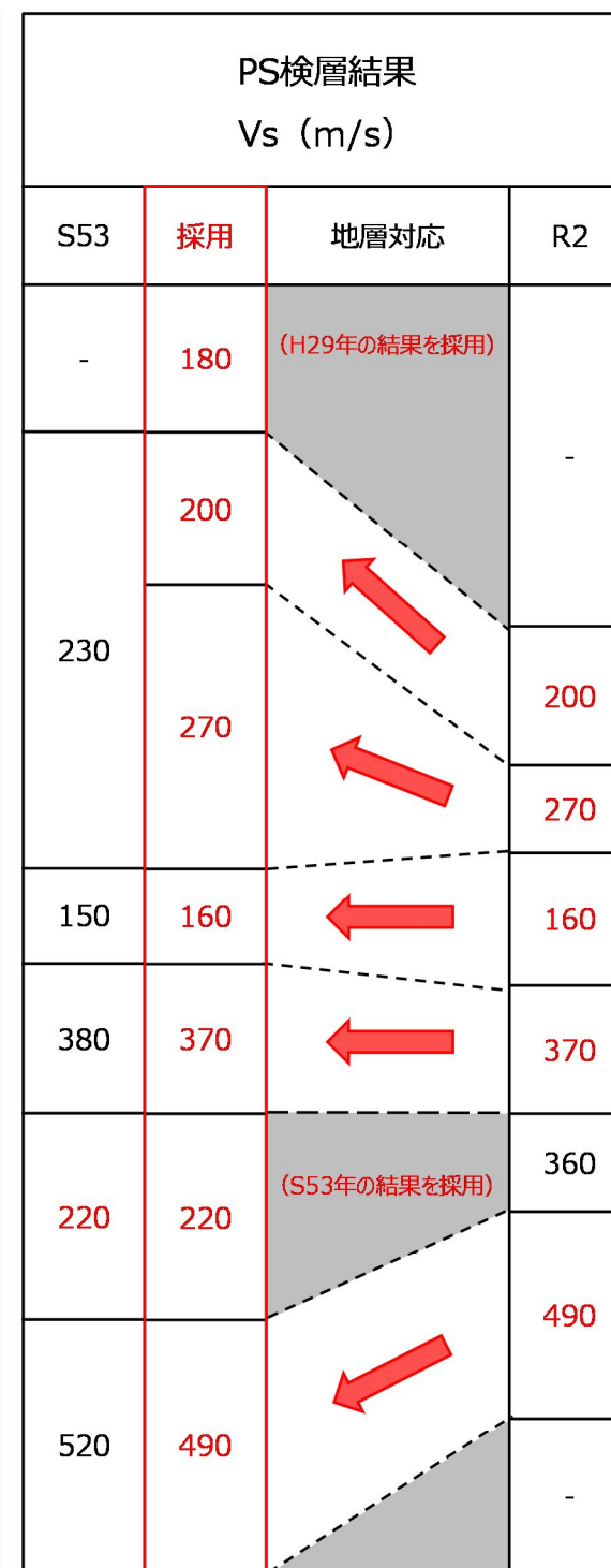
図 2-4 地盤構成と Vs 比較 (左: 昭和 53 年、右: 令和 2 年、赤字: 採用値)
