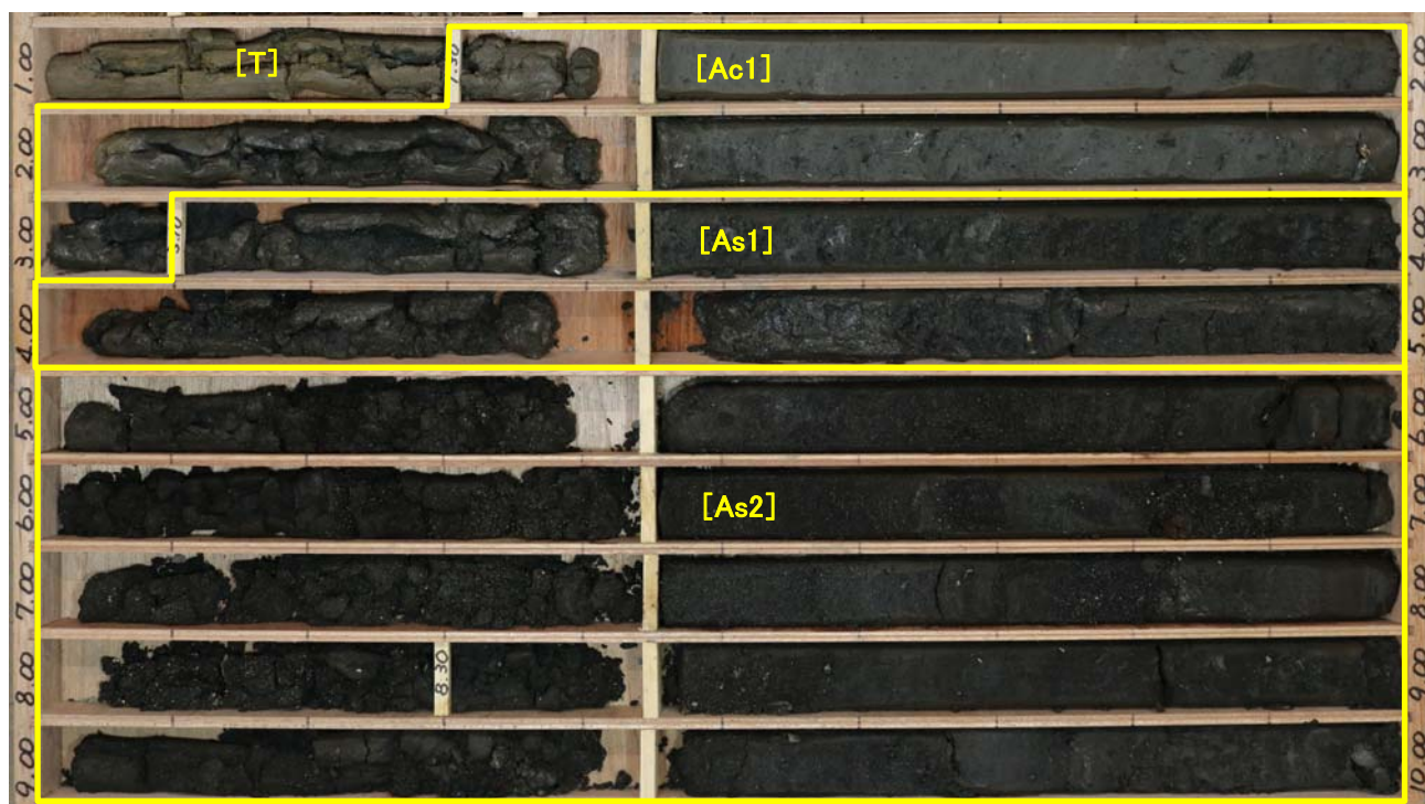
写真 3-2 NO.4 地点における[Ac1, As1, As2]層のコア写真
