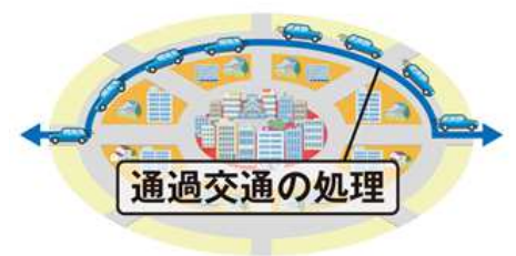
▲環状道路の整備
