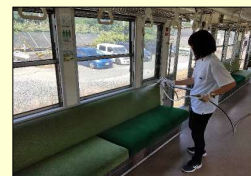
▲ コーティング剤施工
