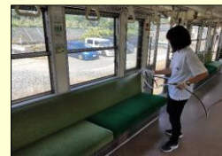
▲ コーティング剤施工
