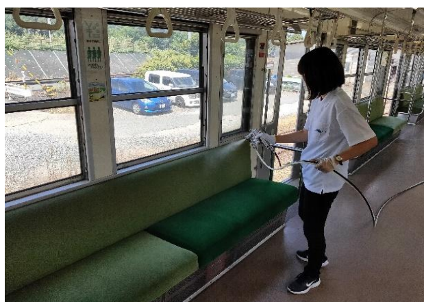
▲ 全車両のコーティング剤施工（熊本電鉄）
