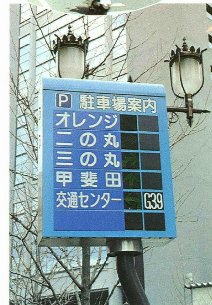
駐車場案内誘導システムの案内板
