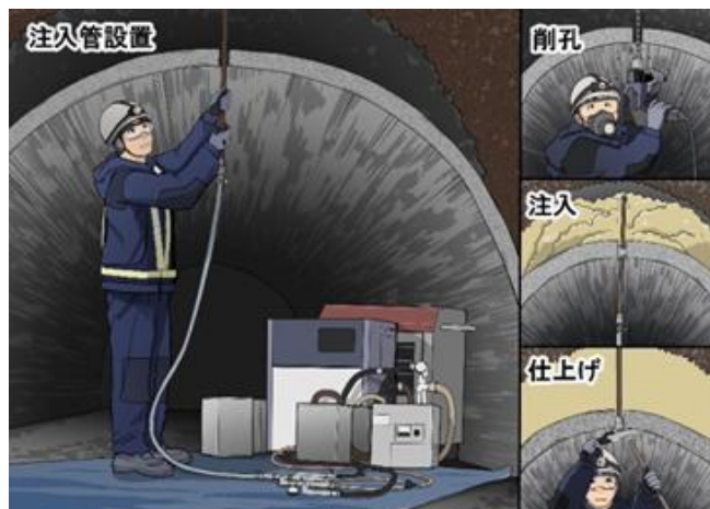
発泡ウレタンによる裏込め注入（工期短縮）
