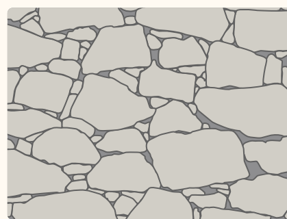
古い時期の石垣の積み方
