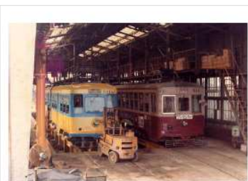
福岡で熊本市電へ改装工事中
