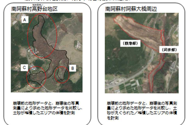
図-15 写真判読による土砂崩壊の体積計測
