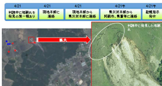
図-17 二次災害の防止(亀裂の発見)
