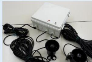
● 移動式音声装置 ※乾電池式
